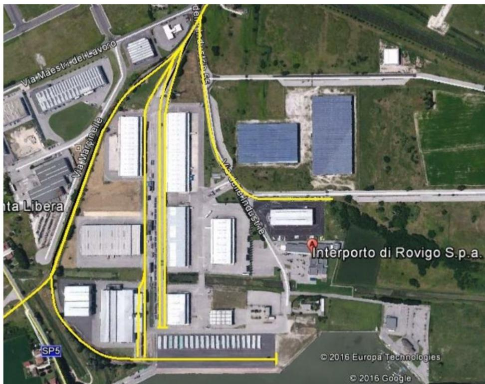
Figura 34 – Raccordo ferroviario all'Interporto di Rovigo
