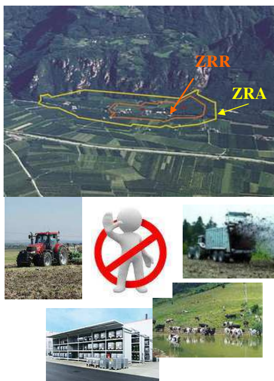
Figura 4 Un esempio di definizione della zona di rispetto ristretta (ZRR) e della zona di rispetto allargata (ZRA) per le captazioni, ove vengono applicati i vincoli dell'art. 16 del Piano di Tutela delle Acque e dell'art.94 del D.Lgs.152/2006.
