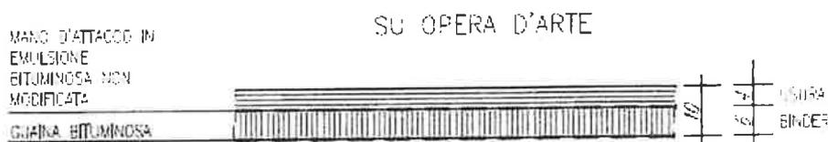
Per i tratti su opera d'arte (cavalcavia o viadotto) il pacchetto pavimentazione risulta composto dai soli strati di Binder ed Usura previa interposizione con la struttura di una guaina bituminosa d'impermeabilizzazione,
