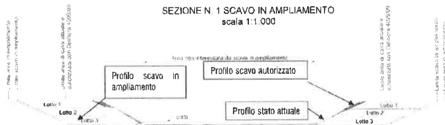
Figura 3.3/III: Estratto non in scala sezione dello stato di progetto di coltivazione in ampliamento
