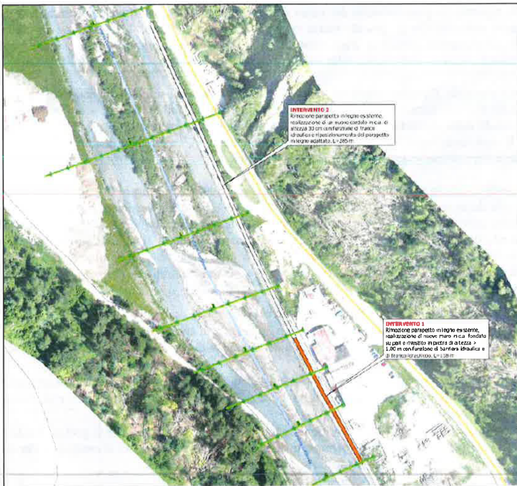
Figura 7 - Planimetria degli interventi previsti nell'ambito dei lavori di "Pulizia del Lago di Alleghe e realizzazione di un sistema di sicurezza in caso di piene"
