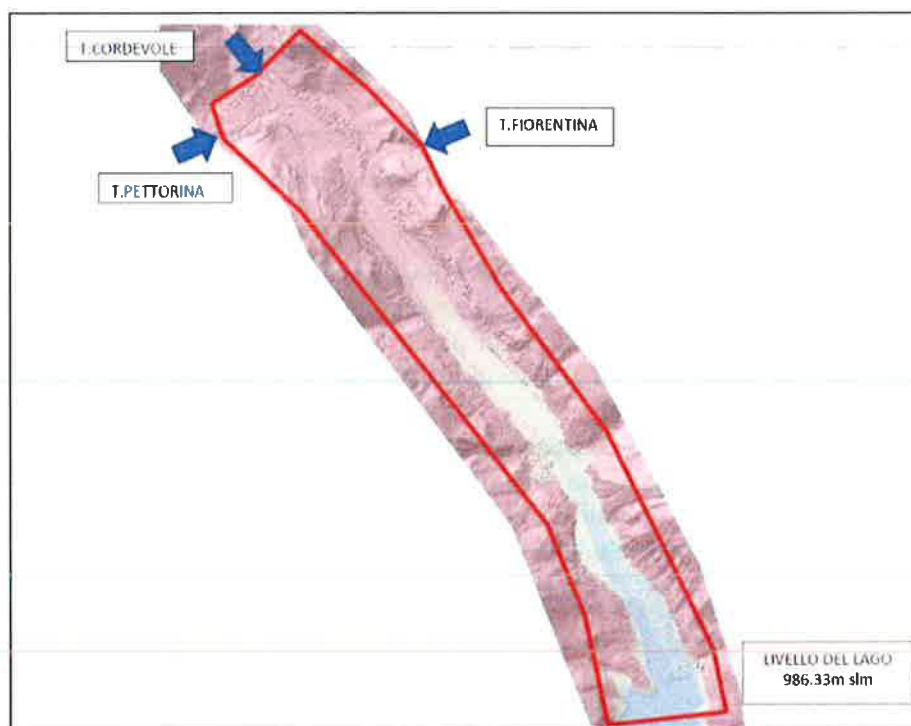
Figura 4 – Modello concettuale BASEMENT del tratto di torrente Cordevole
