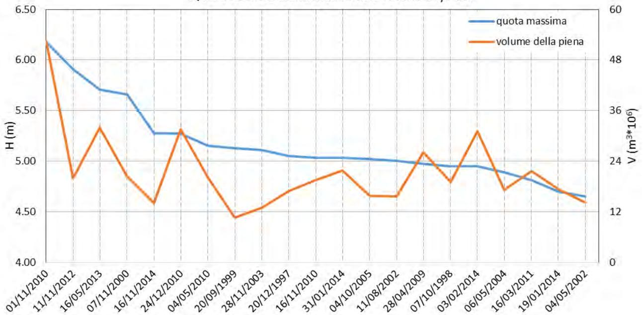
Fig. 2.6 – Valori massimi del livello idrometrico registrato dall'idrometro di Ponte degli Angeli per i 21 eventi superiori a 4.6 m nel periodo 1/1/1997 – 31/5/2016. Il grafico riporta anche il volume della piena valutato mediante la scala delle portate della sezione di Ponte degli Angeli (par. 2.1.2), considerando un intervallo di 3 giorni che va da 24 ore prima del colmo di piena a 48 ore dopo lo stesso.
