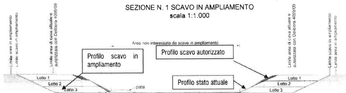
Figura 3.3/III: Estratto non in scala sezione dello stato di progetto di coltivazione in ampliamento
