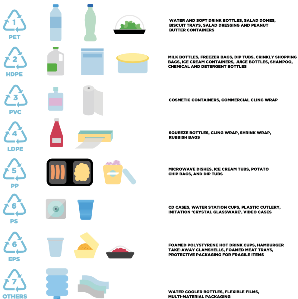
Figura 11 Principali materiali polimerici utilizzati nel packaging e per quali prodotti. Fonte: Ellen MacArthur Foundation, The New Plastic Economy, 2016
