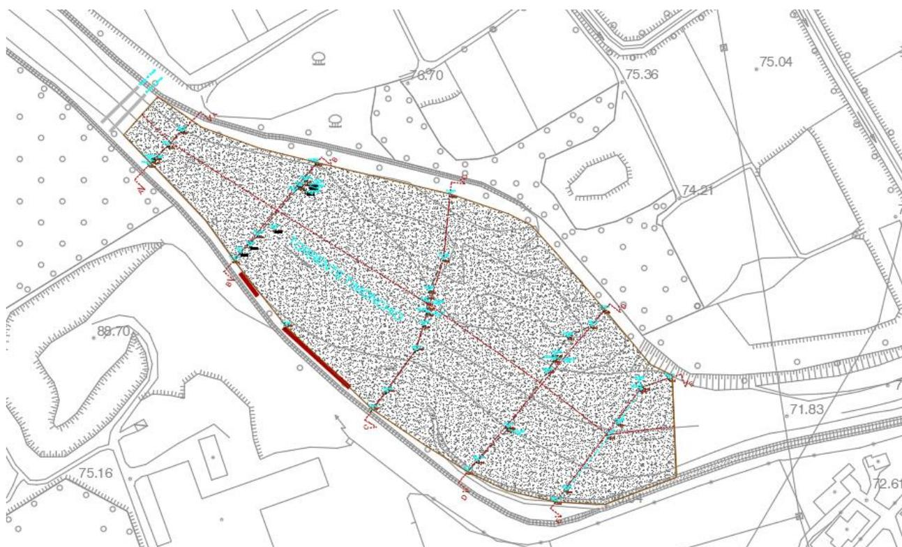
Allo stato attuale il profilo medio del fondo nel tratto corrispondente al bacino naturale rileva delle quote abbondantemente superiori al talweg teorico ottimale. Detto sopralluvionamento facilita la formazione di vie preferenziali di deflusso in particolar modo lungo la sponda destra determinando profondissime arature del fondo.
