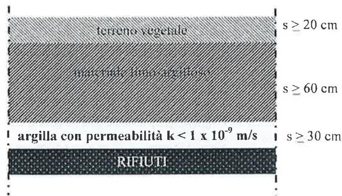
Schema del pacchetto di capping esistente
