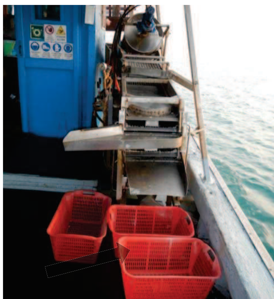
Foto 5.2. Vibrovaglio di una vongolara con le griglie idonee al monitoraggio.
