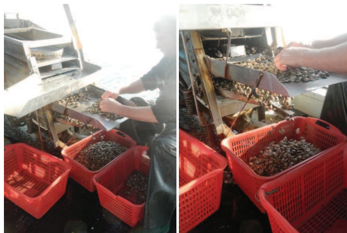
Foto 5.6. Selezione delle vongole per taglia alle diverse griglie del vibrovaglio.
