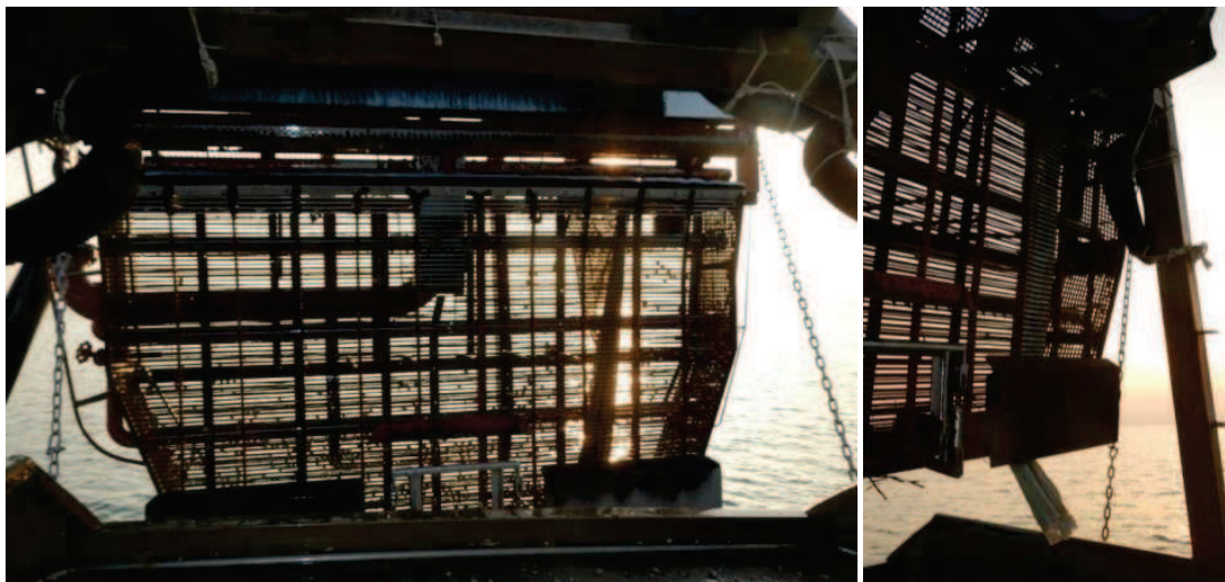
Foto 5.1. Attrezzo di una vongolara con sacco campionatore (cover) all'interno.
