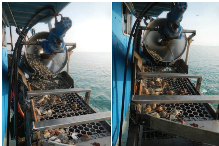
Foto 5.5: Passaggio del prodotto alla vite rotante e successivamente al vibrovaglio.
